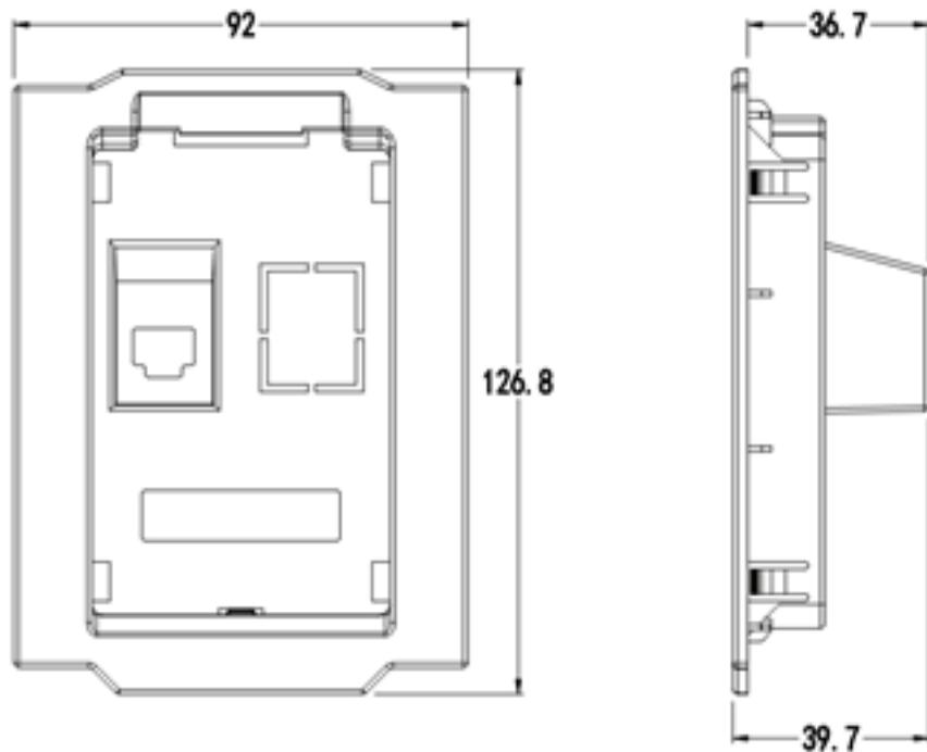
Fig. 3 – Keypad Holder Size (Unit: mm)
